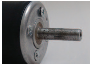
6. Colocando los tornillos nuevamente en su sitio. Nótese el apriete diagonal de los tornillos.
