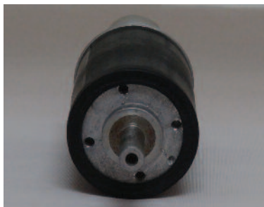
5. Hoof Buffer con la cámara neumática nueva cubriendo correctamente el extremo del buffer.
