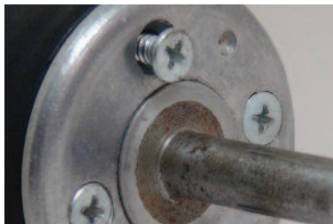
6. Colocando los tornillos nuevamente en su sitio. Nótese el apriete diagonal de los tornillos.
