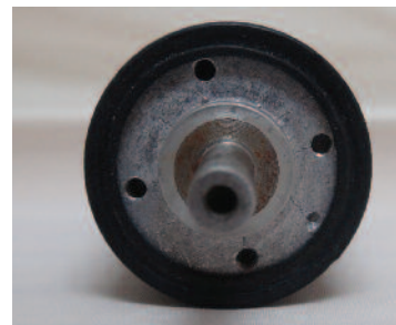
5. Hoof Buffer con la cámara neumática nueva cubriendo correctamente el extremo del buffer.
